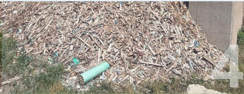
**Étape 4.** Un autre avantage du contrôle du processus de compostage en intérieur est la réduction des odeurs. À l'installation de compostage, l'air est filtré à travers un biofiltre rempli de copeaux de bois, où des micro-organismes naturels décomposent les composés odorants, les neutralisant efficacement avant que l'air ne soit rejeté dans l'environnement.
