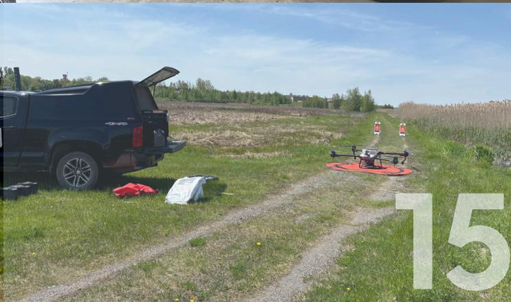
**Figure 15** - Notre drone applicateur en cours de préparation pour le décollage - ce drone est utilisé pour appliquer notre larvicide, tout en minimisant les perturbations au sol dans les zones humides.
