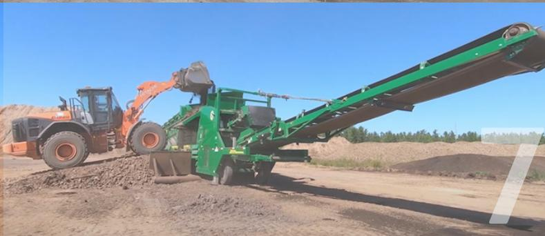
**Étape 7.** Sur la plate-forme de tamisage, le compost est finement tamisé à  $\frac{1}{4}$  de pouce afin d'éliminer toute impureté restante, telle que le verre. Le produit fini est ensuite vieilli, et des échantillons sont envoyés à un laboratoire pour analyse afin de s'assurer qu'il répond aux normes provinciales et nationales avant d'être vendu sur le marché.
